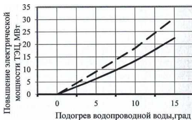
Рис. 2. Зависимость электрической мощности ТЭЦ от относительного расхода сетевой воды подаваемой в системы ГВС. Сплошная линия — относительный расход на ГВС 15 %, пунктирная линия — 20 %
