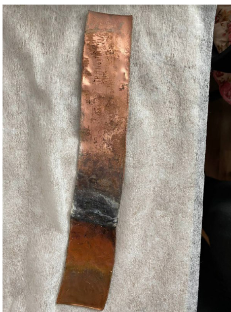
Рис. 3. Вид пластины, находившейся в кипящей воде с добавлением средства борьбы с накипью
