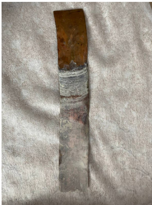
Рис. 2. Вид пластины, находившейся в кипящей проточной воде
