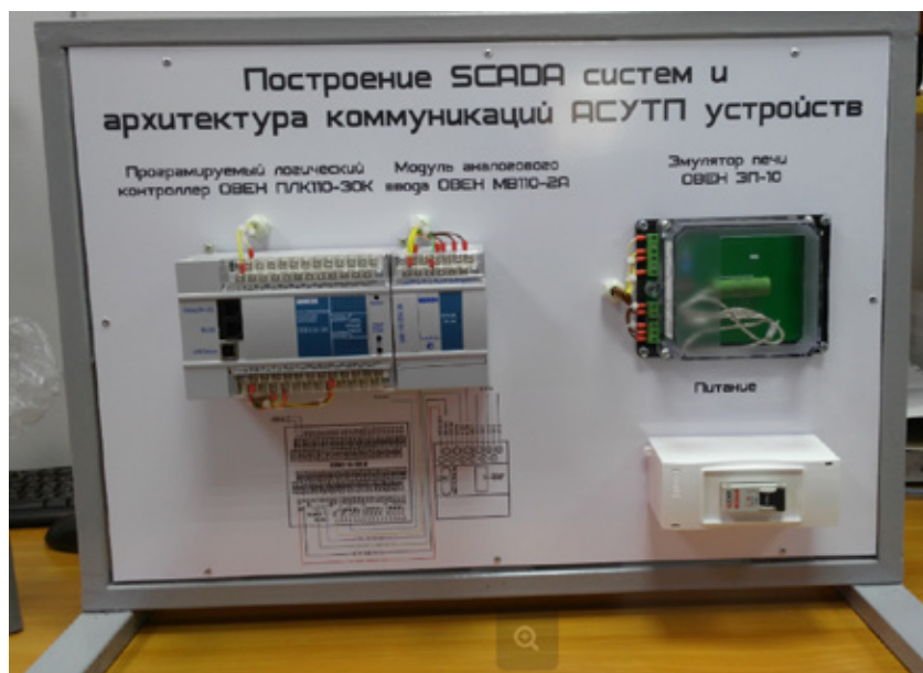
Рис. 18. Разработанный лабораторный стенд для изучения ОВЕН ПЛК
